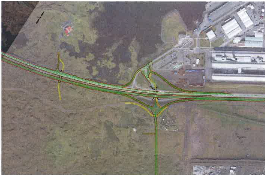
Mynd 1. Myndin sýnir aðstæður við álverið í Straumsvík, núverandi mislæg vegamót með tveimur nýjum hringtorgum, nýjar að- og fráreinar að/frá álverinu sem og að tengivegi að Álhelli, T-vegamót við Straum og stíga/undirgöng fyrir gangandi og hjólandi vegfarendur við álver og Straum sem tengist núverandi stigakerfi (úr matsskýrslu).
